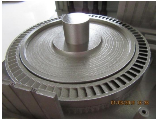
Рис.7. Заготівка колеса турбіни зі сплаву Inconel 718, виготовленого методом Direct Metal Laser Sintering
