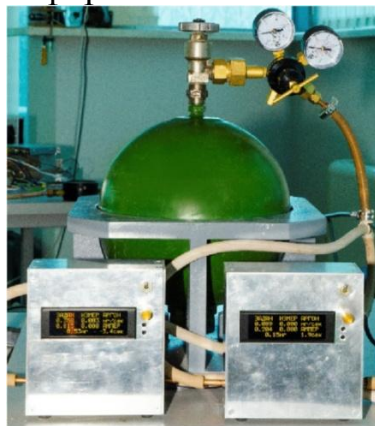
Рис. 2. Лабораторная система хранения и подачи рабочего газа
