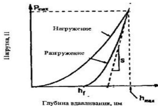
Рис. 2. Зависимости нагрузки  $p$  от глубины внедрения индентора  $h$
