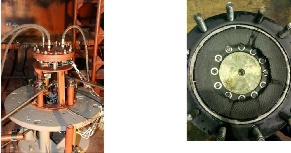
Рис. 6. Образец фланца в испытательной оснастке до и после проведение испытаний
