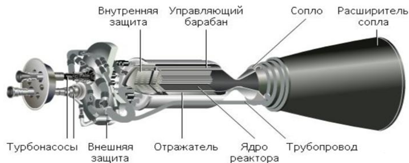
Рис. 1. Схема ядерного ракетного двигателя
