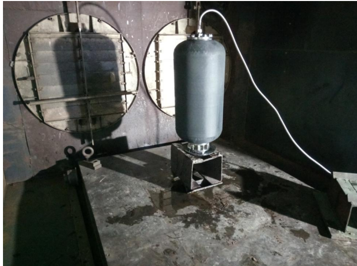
Рис.9 Контроль герметичности топливного бака
