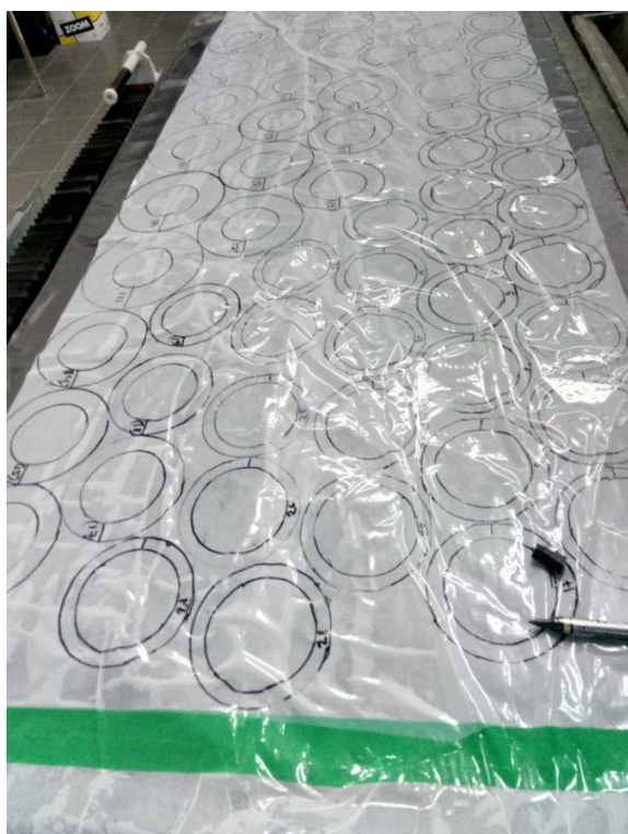
Рис.4 Процесс разметки и раскроя заготовок углеродной ткани
