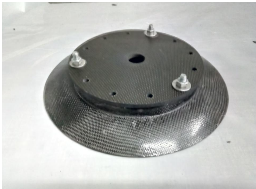
Рис.3 Предварительная стыковка полученной крышки с фланцем
