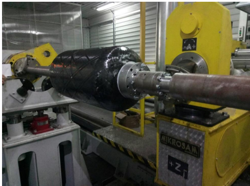
Рис.8 Процесс намотки силовой оболочки корпуса топливного бака
