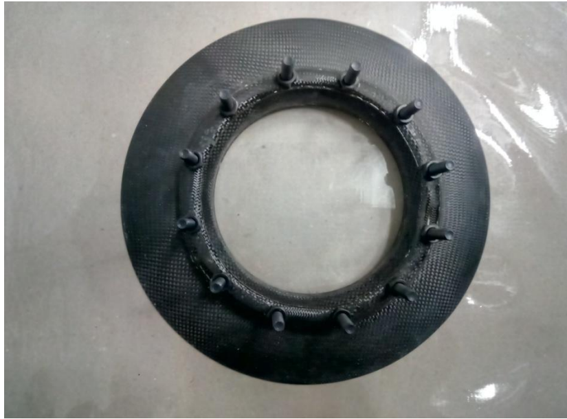
Рис.2 Фланец корпуса топливного бака из углепластика с установленными элементами крепежа
