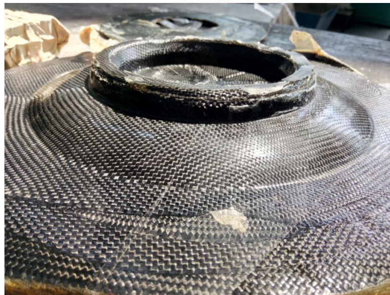
Рис.6 Вид отверженной заготовки фланца из углепластика до механической обработки
