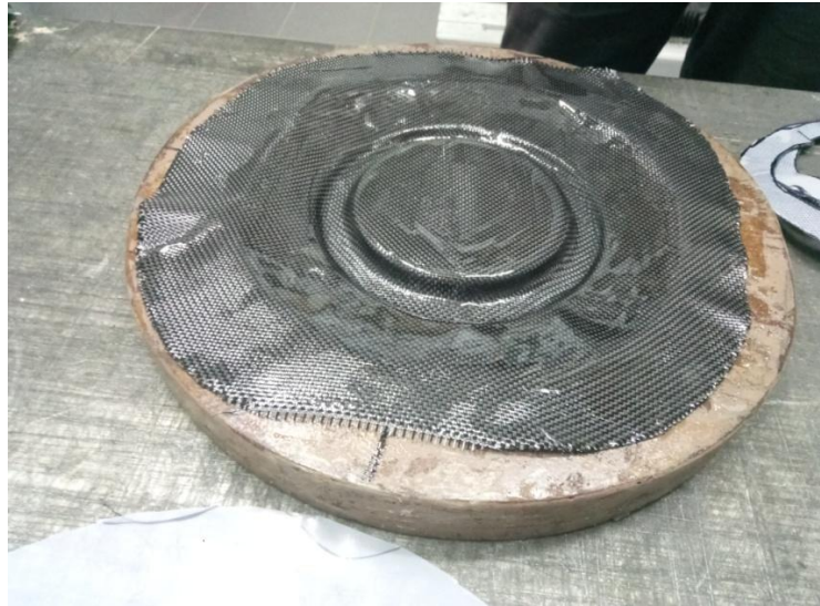
Рис.5 Ручная выкладка раскроенных заготовок
