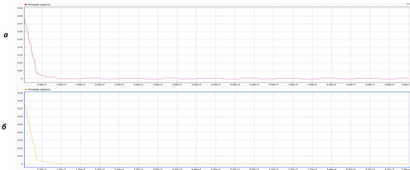
Рис. 4. Переходной процесс изменения скорости при коэффициентах a = 0.7, b = 0.3 : а) \delta = 0.5 , б) \delta = 0.01
