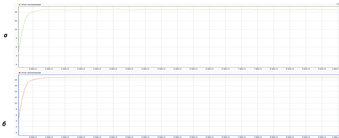
Рис. 5. Переходной процесс изменения угла при начальной угловой скорости 5 град/с с коэффициентами a=0.7, b=0.3 : а) \delta = 0.5 , б) \delta = 0.01
