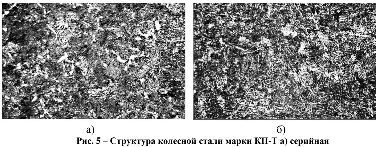
Рис. 5 – Структура колесной стали марки КП-Т а) серийная немодифицированная, б) модифицированная ; x900.
