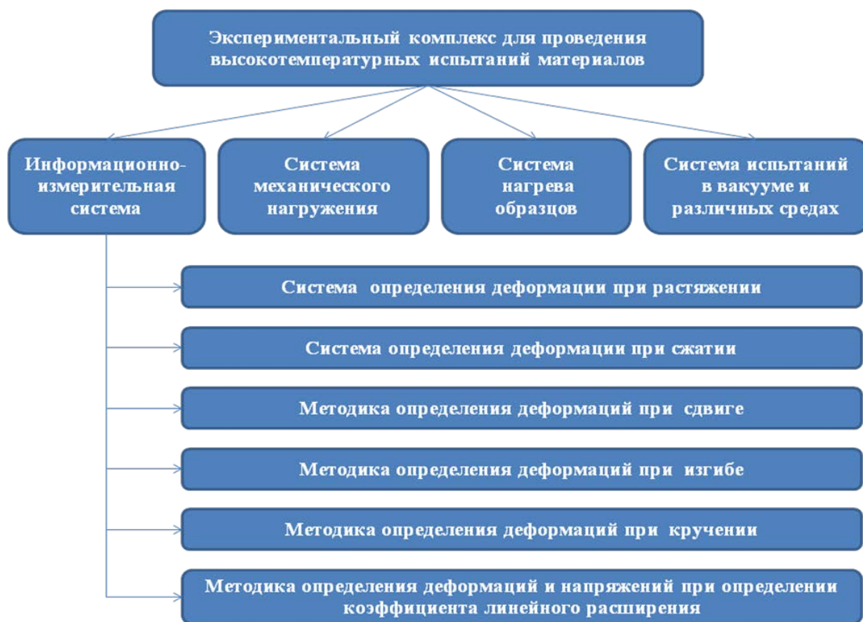
Рис. 1. Структурная схема экспериментального комплекса для проведения высокотемпературных испытаний материалов
