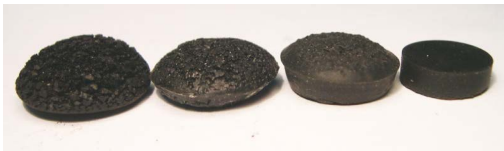
Рис. 4. Внешний вид образцов №№ 4 -6 после испытаний с возгоранием
