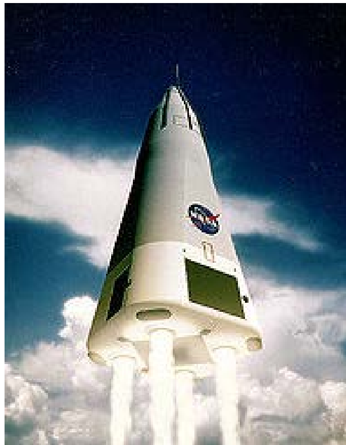
Рис. 10 – Реалізований льотний прототип, DC-X, одноступеневої повністю багаторазової РН з вертикальним зльотом і посадкою «Delta Clipper» [51]
