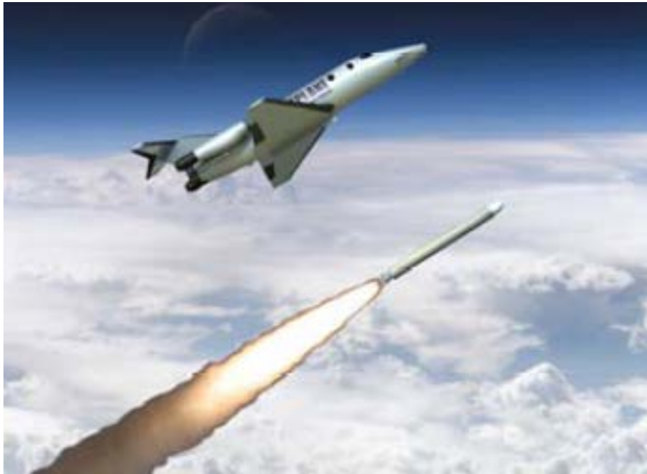
Рис. 13 – Одна з сучасних пропозицій запуску мікросупутників – повітряно-космічний літак править за розгінний блок для мікроРН [48]
