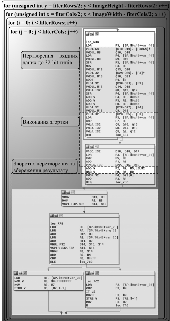
Рисунок 1 – Приклад авто-векторизації операції згортки, отриманий за допомогою програми IDA Pro (1)
