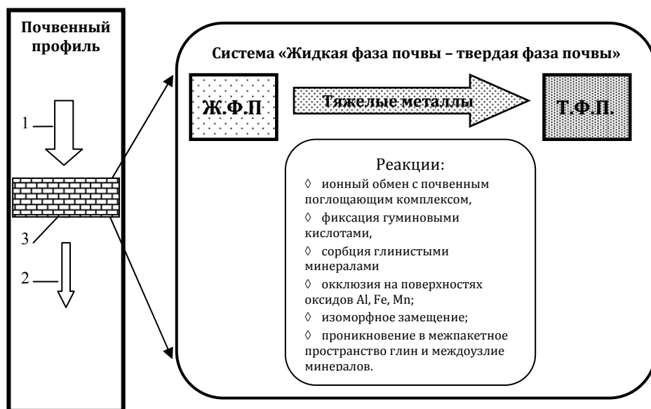
Рис. 2. Принцип действия и основные компоненты педогеохимического барьера
