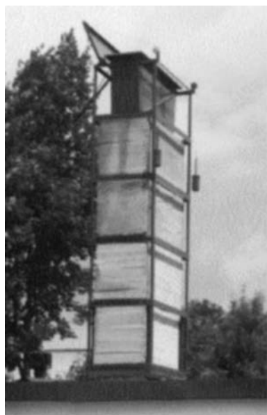
Рис. 4. Генератор инфразвука вертикального типа Львовского отделения института космических исследований НАНУ
