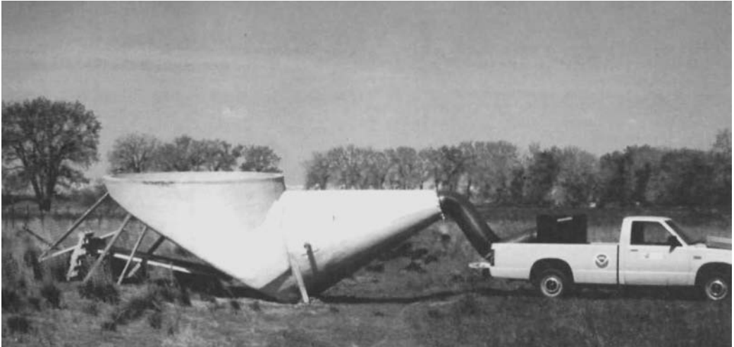
Рис. 6. Генератор низкочастотных акустических колебаний (США, Колорадо [12])
