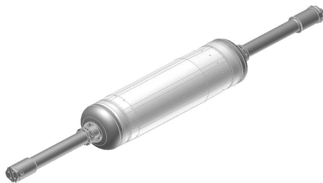
Рис. 4. Общий вид оправки в сборе
