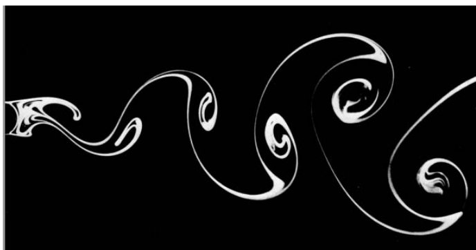
Рис. 2. Результаты экспериментальной визуализации вихрей при обтекании цилиндра для Re=140 [6]
