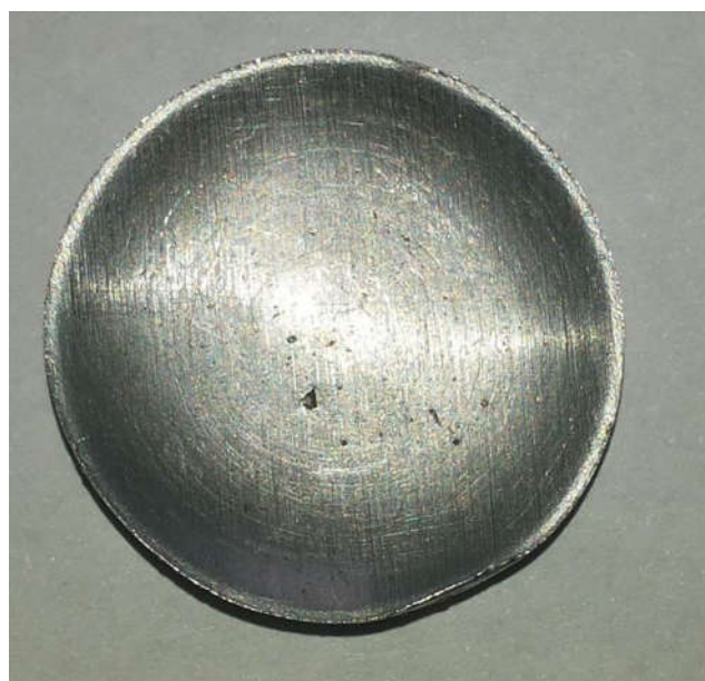
Рис. 2. Часть разрушенной мембраны
