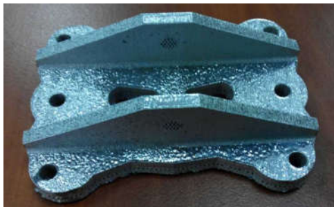
Рис. 5. Заготовка кронштейна, напечатанная из материала Inconel625
