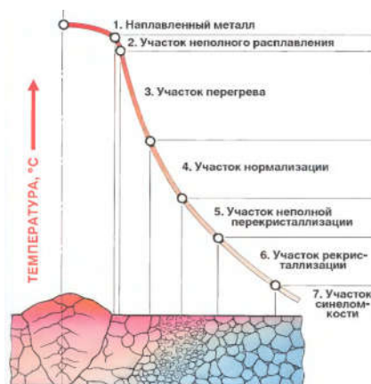
Рис. 3. Термический цикл в сварном шве
