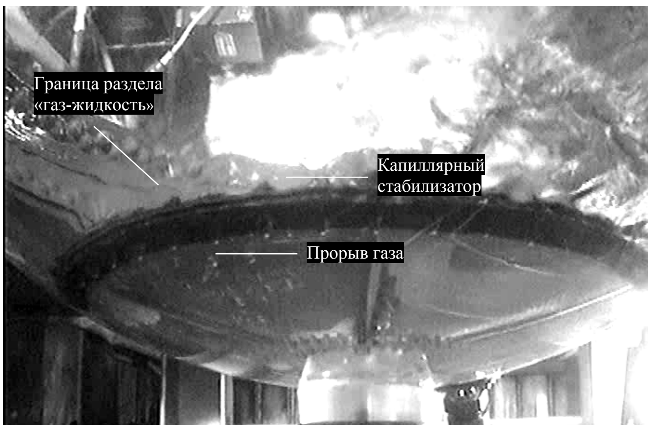
Рис. 4. Положение жидкости в момент окончания действия продольного ускорения (зафиксирован прорыв газа под стабилизатор)
