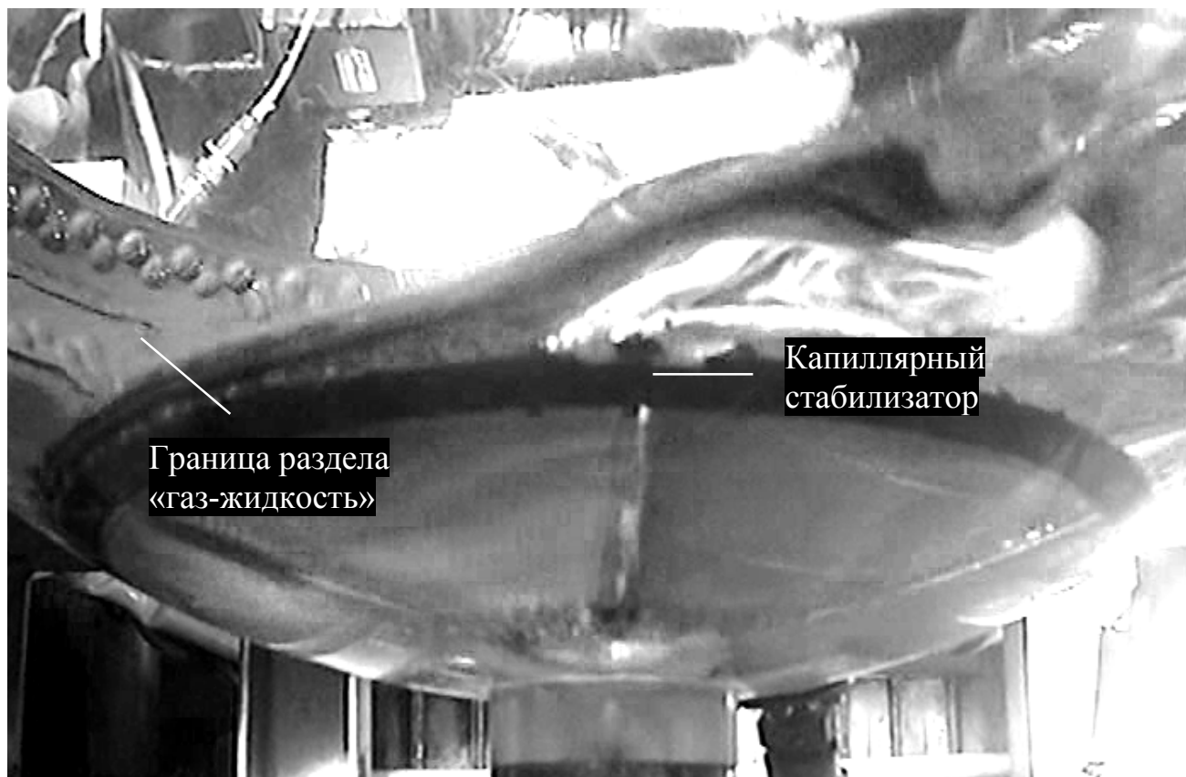
Рис. 6. Положение жидкости в момент окончания действия продольного ускорения (прорыв газа под стабилизатор не зафиксирован)
