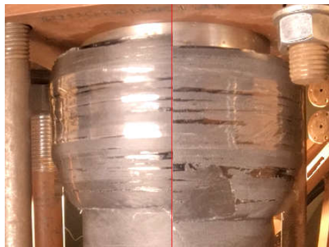
Рис. 4. Визуальное представление деформации макета под действием внутреннего давления
