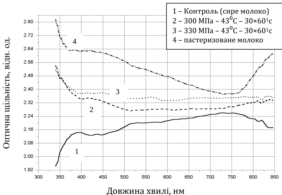
Рис. 8. Спектральні характеристики дослідних зразків молока при товщині шару 0.6 мм Fig. 8. Spectral characteristics of experimental samples milk at a layer thickness of 0.6 mm
