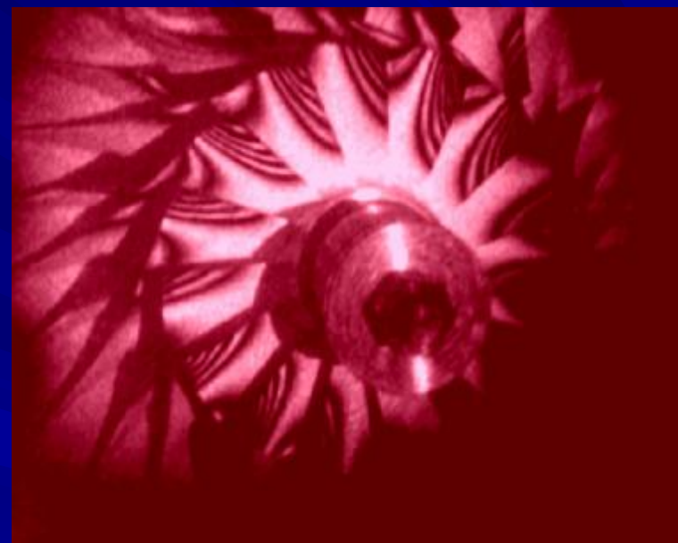
Форма коливань на резонансній частоті 4925 Гц
