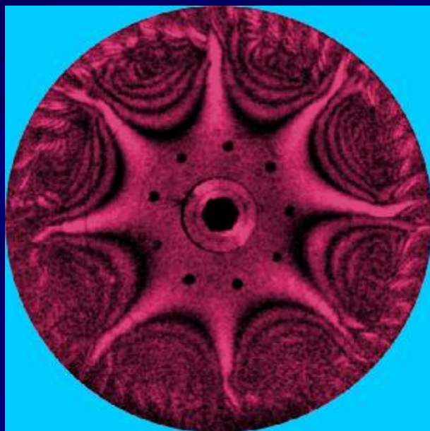
Форма коливань на резонансній частоті 4455 Гц
