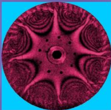
Форма коливань на резонансній частоті 4455 Гц
