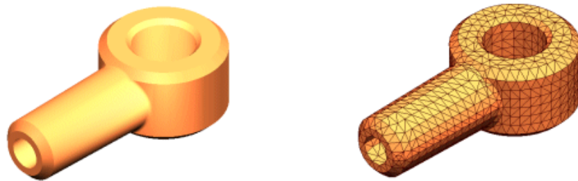
Рисунок 4.1 – CAD-модель і модель розбита на сітку елементів
