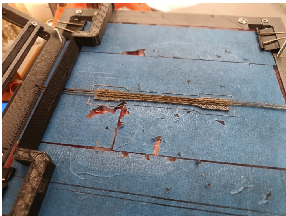
Рисунок 3.8 – Прокладене волокно перед друкуванням закріплюючого шару
