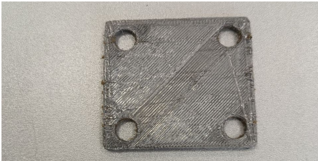
Рисунок 4.10 – Приклад зразка після обрізки залишкового волокна
