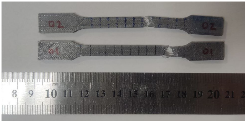
Рисунок 3.13 – Зразки 1 та 2 з партії зразків без армування після випробувань
