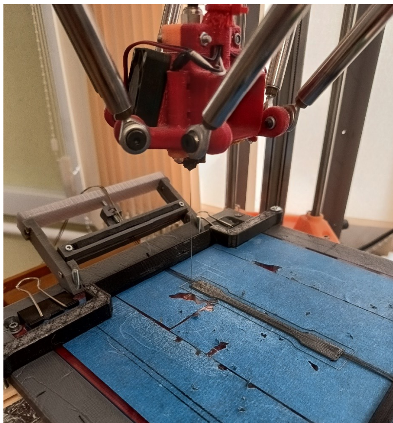
Рисунок 3.10 – Постановка друку на паузу і відведення друкувальної головки
