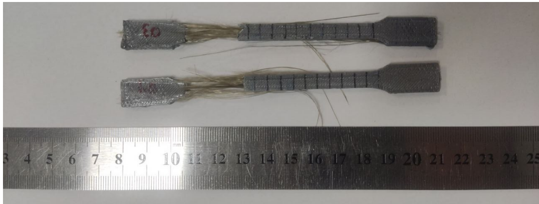
Рисунок 3.14 – Зразки 3 і 4 з партії зразків з армуванням після випробувань
