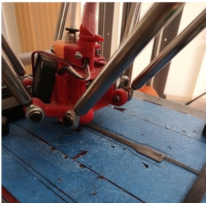
Рисунок 3.9 – Процес друкування закріплюючого шару
