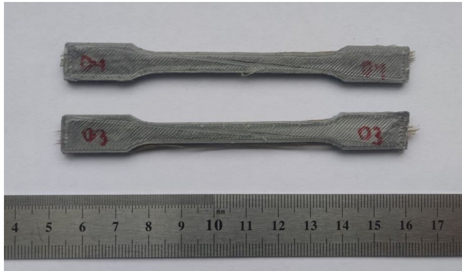
Рисунок 3.12 – Зразки 3 і 4 з партії зразків з армуванням
