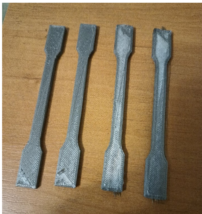
Рисунок 3.11 – Частина комплекту зразків, пара без армування і пара з армуванням
