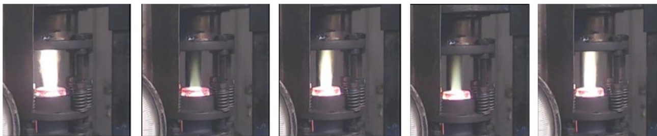
Рисунок 1.14. Стоп-кадри із відеозйомки вогневого випробування моделі автофажного двигуна. Зафіксовано пульсаційний режим роботи на частоті близько 3Гц. [32]
