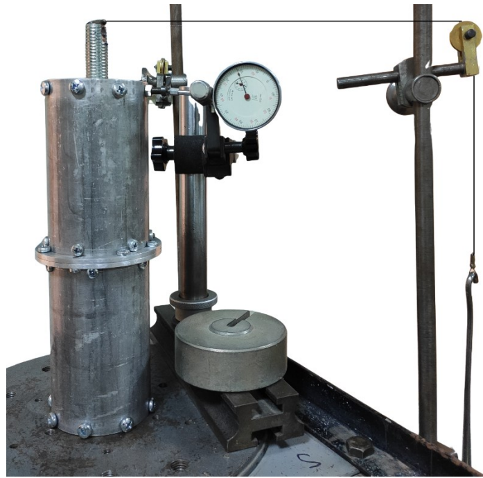
Рис. 4.4 – Експеримент на поперечний вигин
