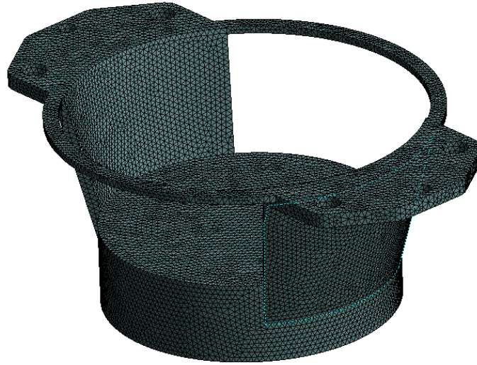
Рисунок 4.2.2 – Скінчено-елемента сітка конструкції кронштейну кріплення до топологічної оптимізації
