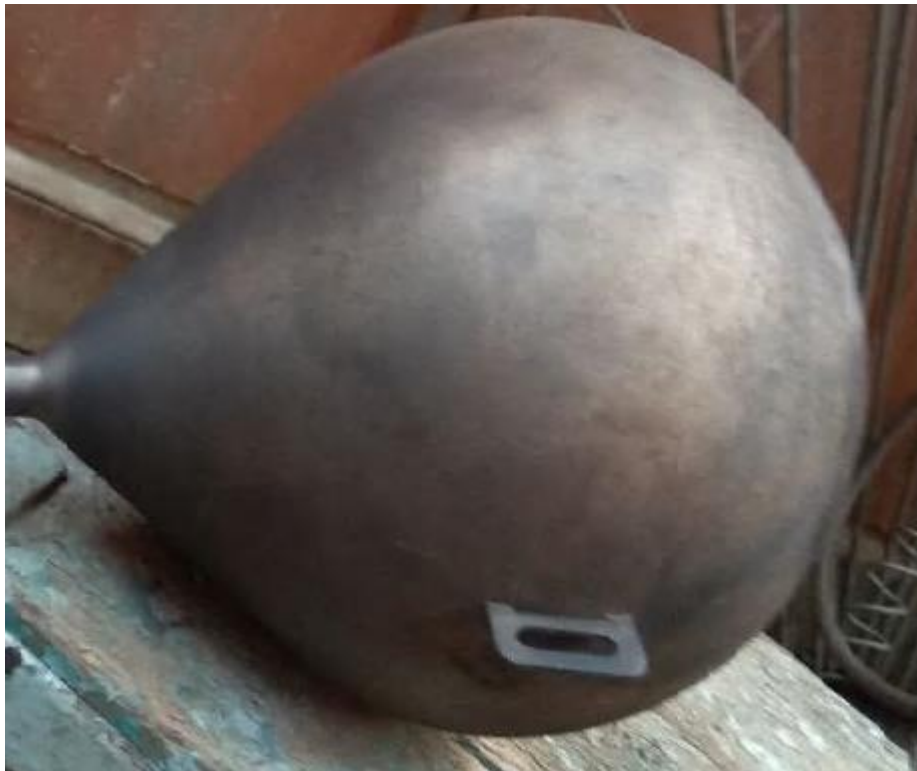
Рисунок 4.1.3 – Виготовлений балон високого тиску на випробувальному стенді
