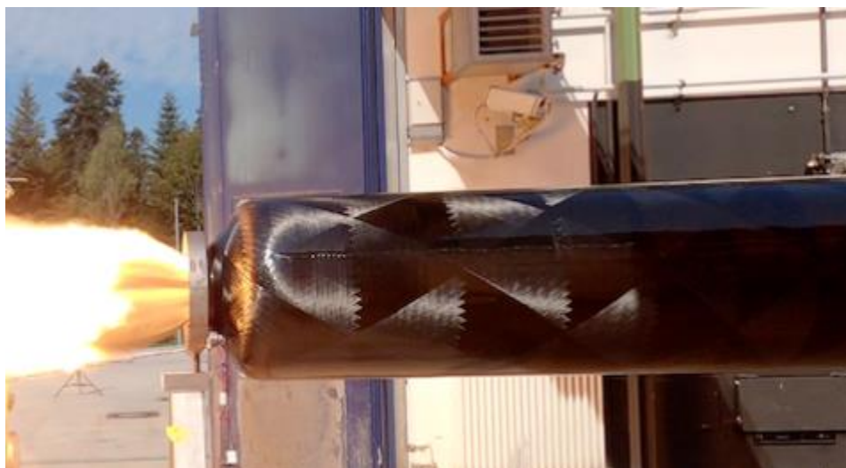
Рисунок 1.1.4 – Несучий корпус ракетного двигуна на твердому паливі з вуглепластику
