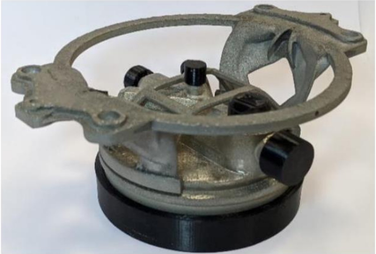
Рисунок 4.2.10 – Конструкція кронштейну кріплення після випробувань
