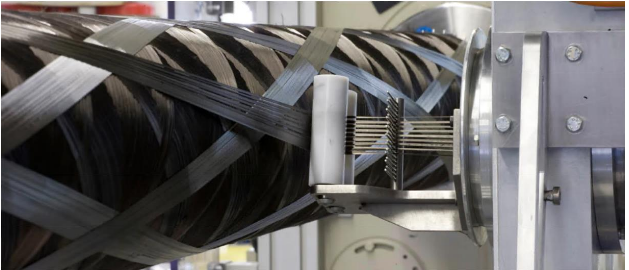
Рисунок 2.1.2.2 – Ілюстративний приклад процесу намотки композитної конструкції з вуглепластику
