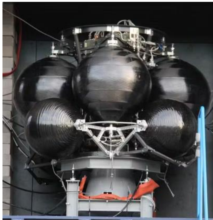
Рисунок 1.1.1 – Вуглепластикові балони високого тиску
