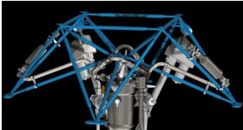
Рисунок 1.1.3 – Силова рама двигуна тягою 250 кгс
