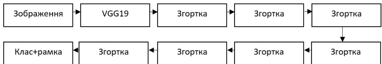
Рисунок 1.9 – Схема оброблення зображення методом SSD
