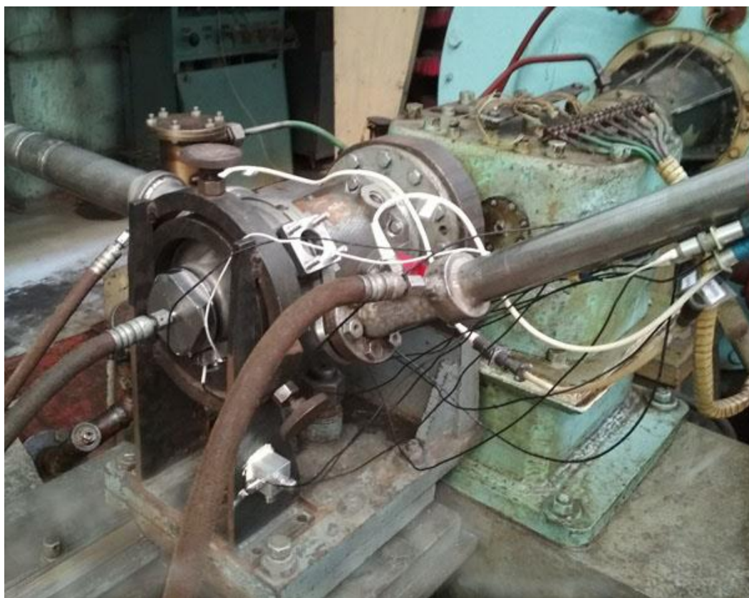
Рисунок 2.2 – Насос встановлений на лабораторного стенда для проведення наукових досліджень
