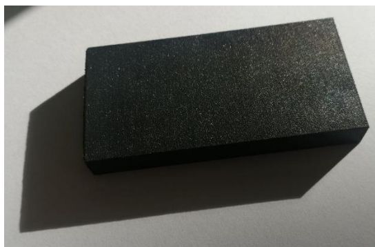
Рис.4.11 – Загальний вигляд якості поверхні зразків-свідків отриманих друком.
