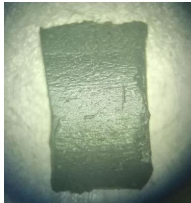
Рис.4.5 – «Відбиток» профілю жолоба лопатки.
