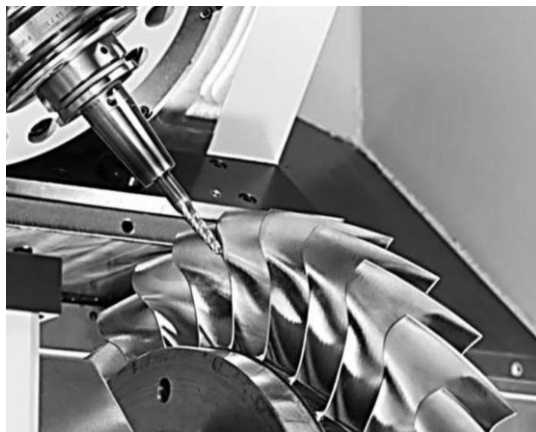
Рис.1.7 – Чистова обробка міжлопаткових каналів сферично-конічною фрезою [54].
