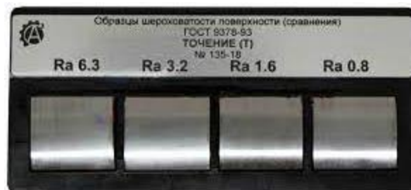
Рис.4.4 – Еталонні зразки шорсткості поверхні (точіння).
