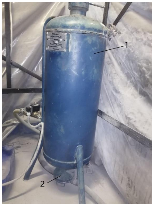
Рис.4.17 – Апарат абразивно-струменевий :1- бак, 2- кран шиберний.
