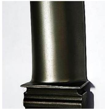
Рис.1.15 – Поверхня турбінної лопатки після обробки методом ГАО на стаціонарному обладнанні [102].
