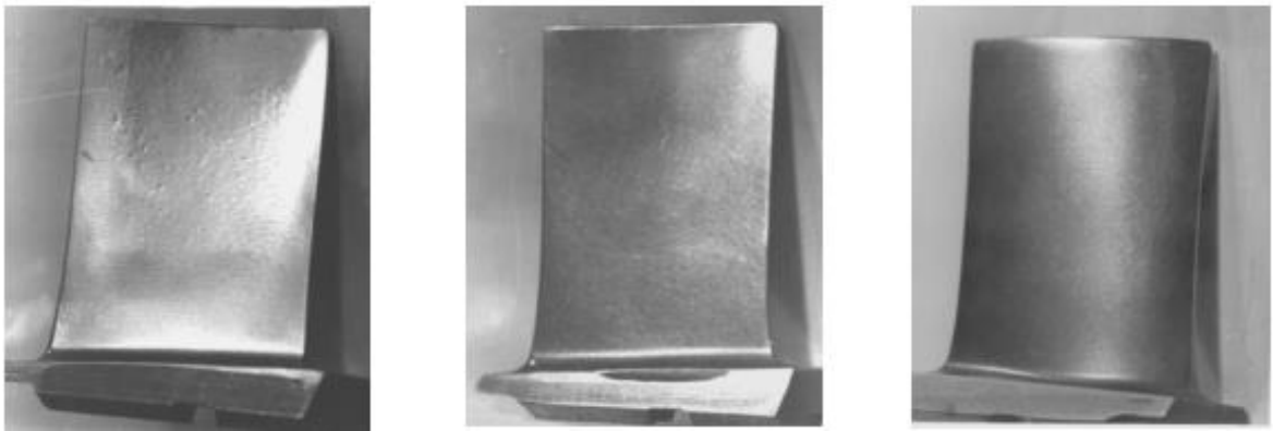
Рис.1.9 – Зовнішній вигляд лопаток після МАО[67].
