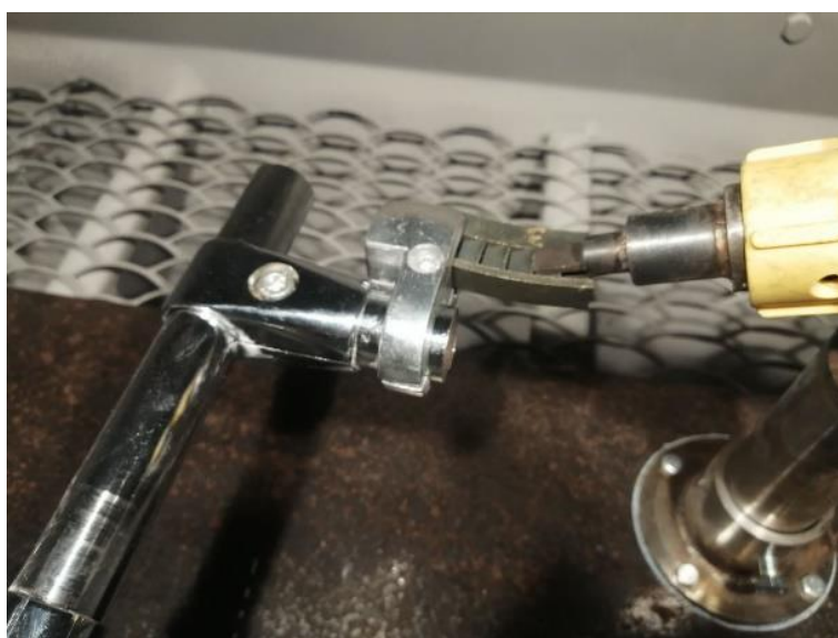
Рис.4.19 – Сегмент лопаток перед обробкою.
