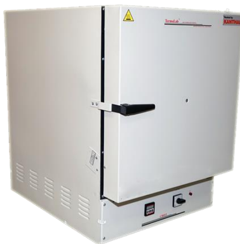
Рис.2.5 – Муфельна лабораторна піч СНОЛ - 40/1300.
