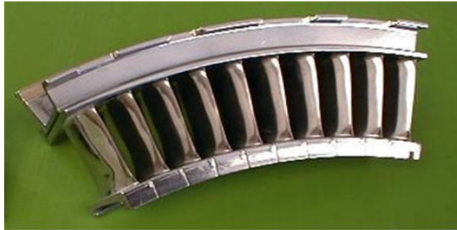
Рис.1.12 – Турбінні лопатки поліровані планетарно-ротаційним методом.
