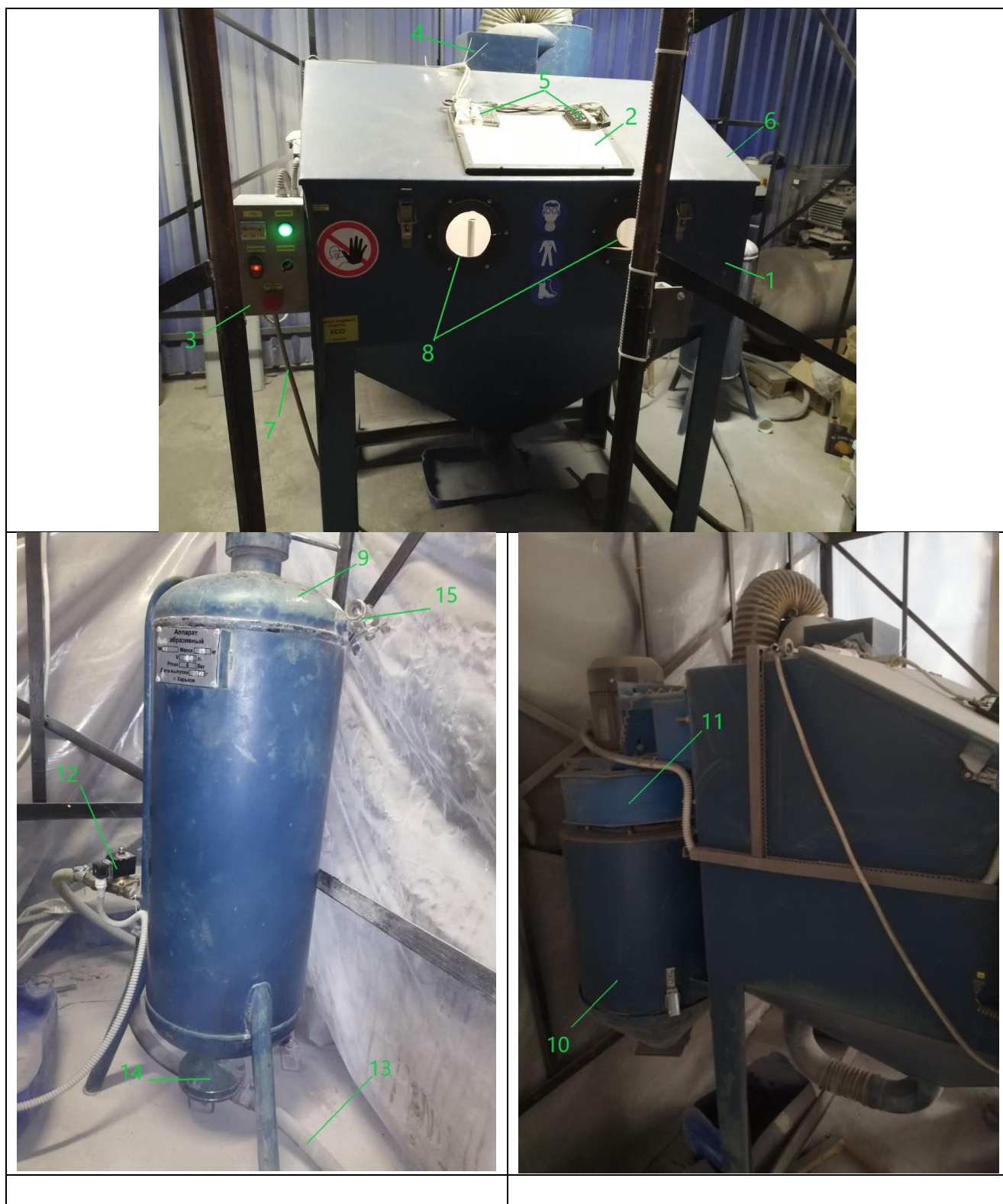
Рис.2.15 – Камера струменевого очищення: 1-камера, 2-вікно, 3-шкаф керування, 4-шибер, 5-освітлення, 6-кришка завантажування, 7-8-рукав захисний, 9-апарат абразивно-струменевий, 10-сепаратор циклонний, 11-вентилятор витяжний 3кВт, 12-клапан електромагнітний, 13-рукав Ø19/33, 14-кран шибєрний, 15-вентиль.
