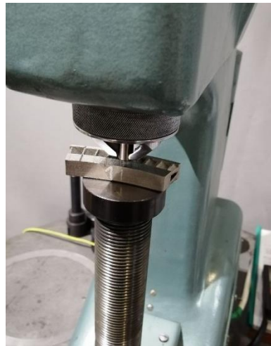
Рис.2.6 – Контроль твердості зразків до ТО за допомогою твердоміра ТК-2М.
