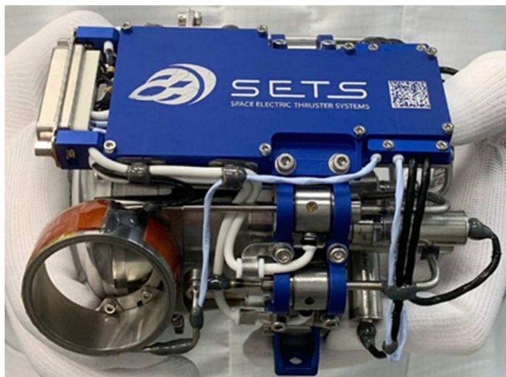
Рисунок 3.34 – Загальний вид системи подачі для електрореактивної двигунної установки SPS-25
