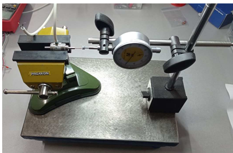
Рисунок 3.14 – Забір ходу електроклапану
