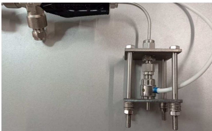
Рисунок 3.13 – Оснащення для утримання електроклапану при подачі високого тиску
