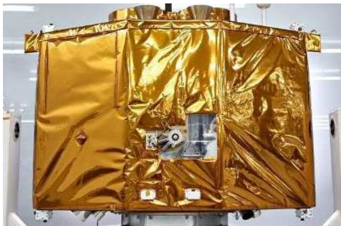
Рисунок 4.3—Супутник EOS SAT-1 з інтегрованим ЕРДУ
