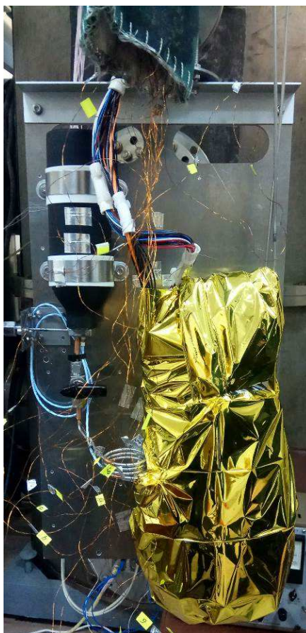
Рисунок 3.31–Зібрана система подачі з лабораторним балон перед встановленням у стенд TVK-2.5
