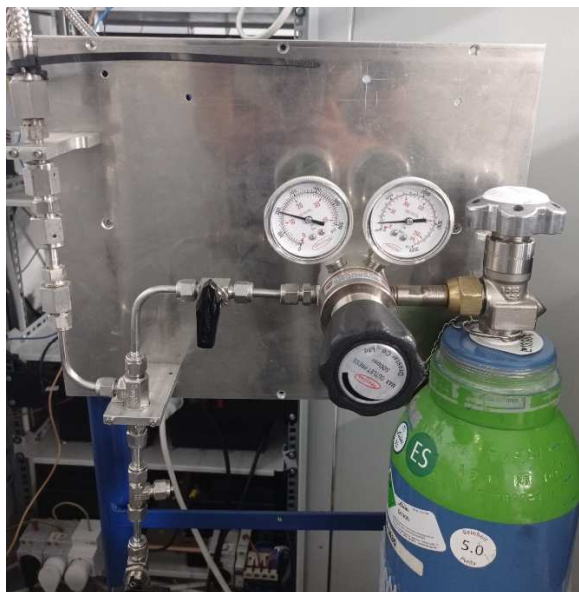
Рисунок 3.1 – Лабораторна система заправки
