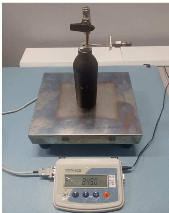
Рисунок 3.4 – Процес зважування балону для отримання експериментальних даних по заправці робочої речовини.
