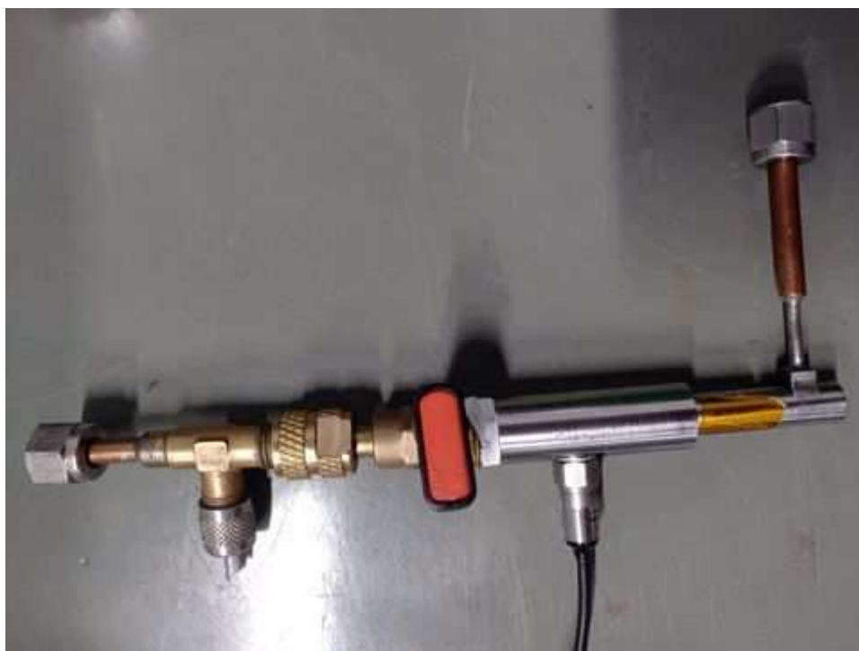
Рисунок 3.19 – Оснащення для випробування обмежувачів витрати
