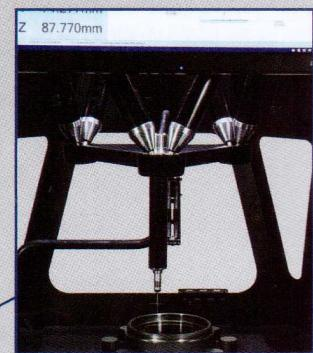
Надійна конструкція з використанням лінійних двигунів та механічних підшипників.
