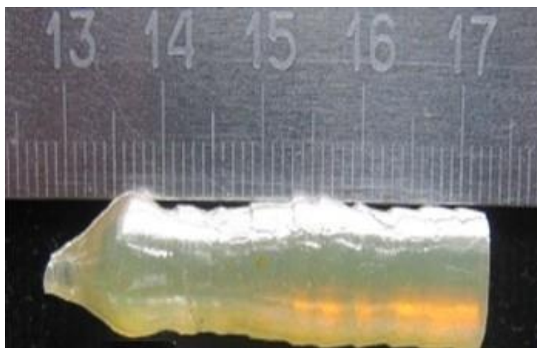
Рисунок 2.1 – Кристал NBT, вирощений методом Чохральського.
