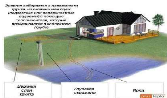
Рисунок 1 – Общий вид системы энергообеспечения с тепловым насосом
