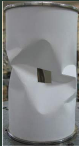
Рисунок 6 – Форми втрати стійкості циліндричних оболонок під дією стискаючих зусиль та експериментальні дані критичного крутного моменту для оболонок з одним круговим або квадратним отвором
