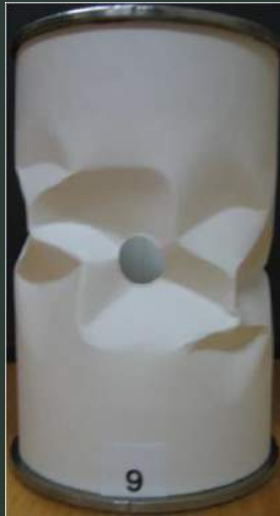
Рисунок 6 – Форми втрати стійкості циліндричних оболонок під дією стискаючих зусиль та експериментальні дані критичного крутного моменту для оболонок з одним круговим або квадратним отвором
