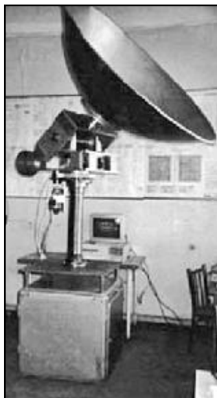
Абонентський модуль, призначений для прийому інформації з низькоорбітальних супутників з високою швидкістю. Його створила кафедра систем автоматизованого управління ДНУ – професор В. О. Ларін, доцент А. М. Кулабухов, ст. викладачі Г. І. Панфілов, В. В. Беліков, студенти. Абонентський модуль прошов випробування з антеною діаметром 1,6 м.
