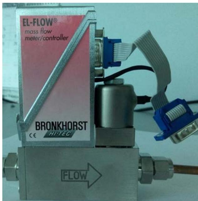
Рис. 3. Блок регулятора витрат газу фірми Bronkhorst
