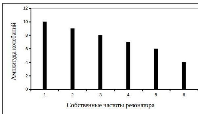
Рис. 4. Условная спектральная амплитудно-частотная характеристика резонатора
