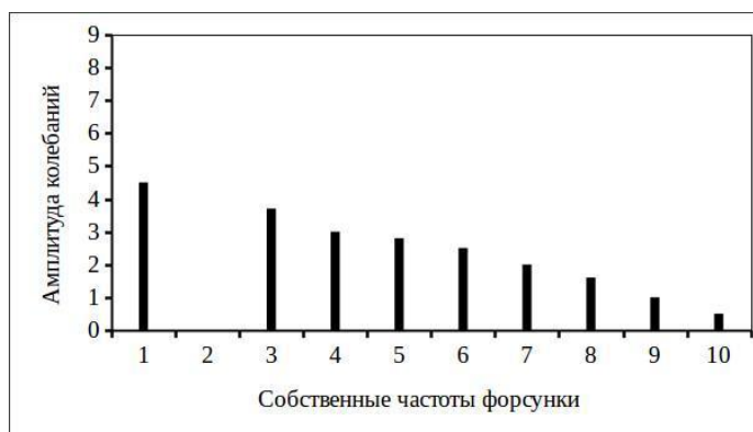
Рис. 5. Условная спектральная амплитудно-частотная характеристика колебаний, возбуждаемых в потоке при протекании воды через щель с постоянной скоростью
