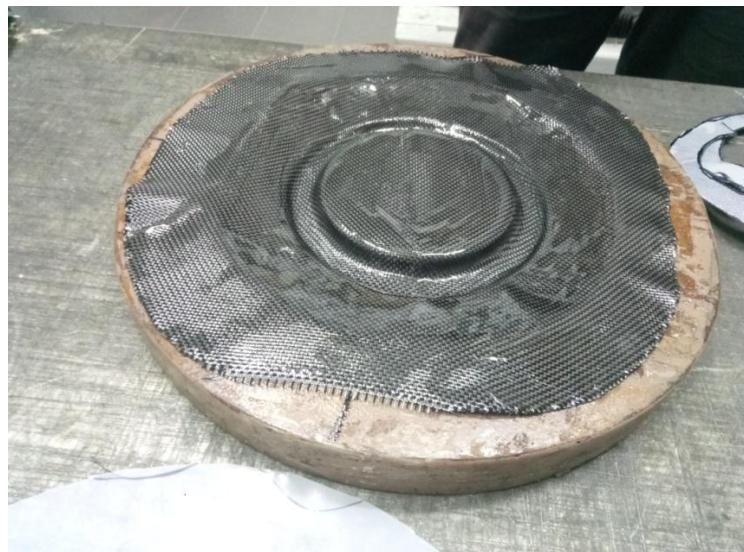
**Рис.5 Ручная выкладка раскроенных заготовок**
