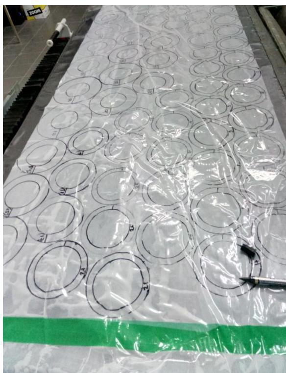
**Рис.4 Процесс разметки и раскрай заготовок углеродной ткани**
