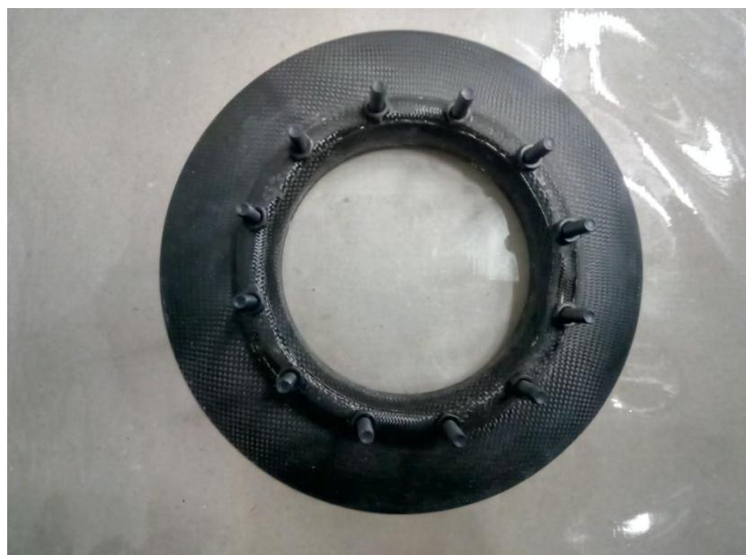
**Рис.2 Фланець корпуса топливного бака из углепластика с установленными элементами крепежа**
