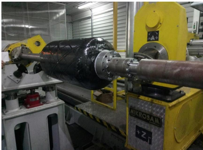
**Рис.8 Процесс намотки силовой оболочки корпуса топливного бака**
