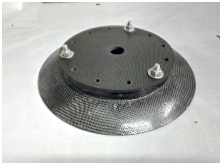
**Рис.3 Предварительнаястыковка полученной крышки с фланцем**
