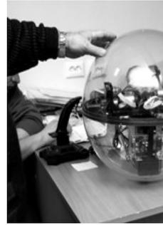
Рис. 2. Робот-шар
