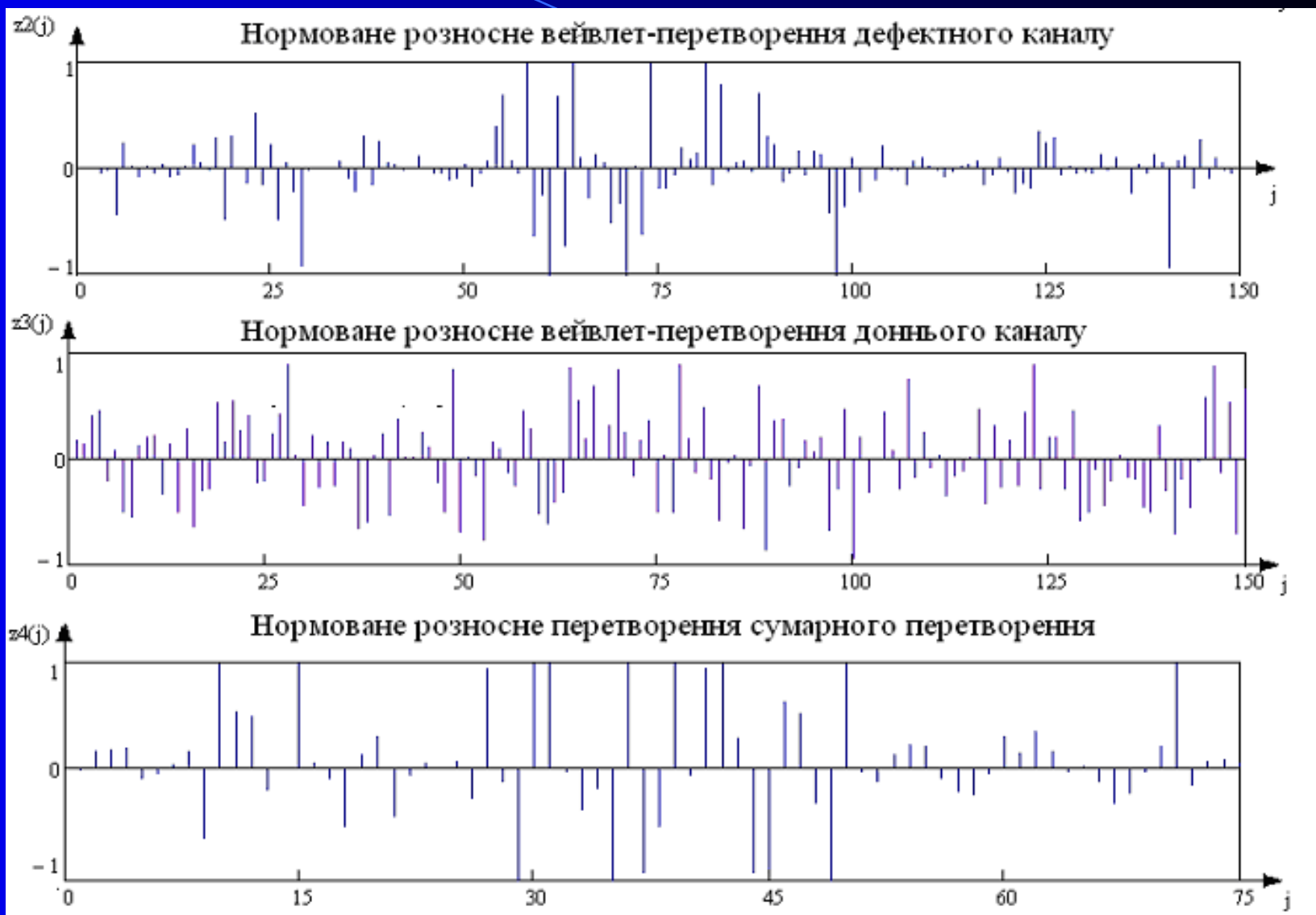
Рис.1. (продовження) Фрагменти вибірок вихідних вимірів труби з дефектом і їх нормовані сумарно-розносні вейвлет-перетворення
