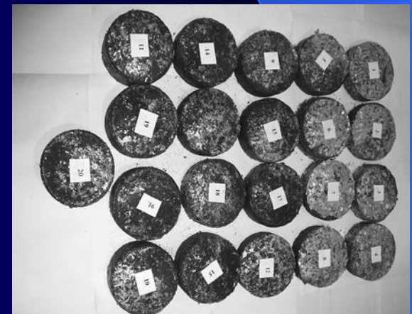
Частина модифікаторів дослідно-промислової партії, якою обробляли колісну сталь R7 на ВАТ ІНТЕРПАЙП НТЗ
