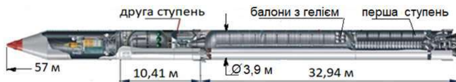
Рис.2 – Несучі циліндричні баки РУ РН «Зеніт» [12]
