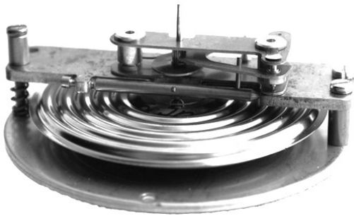
Рис. 10. – Гофрована мембрана з передавальним механізмом
