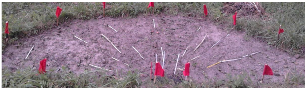
Рис. 2.7. Модельний дослід латеральної міграції нафти у ґрунт
