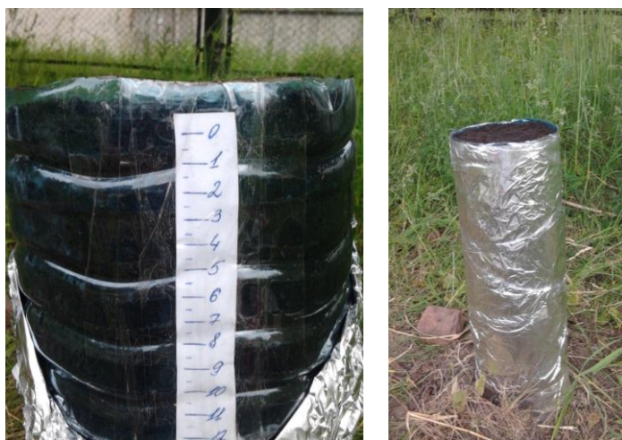
Рис. 2.6. Модельний дослід вертикальної міграції нафти у ґрунт
