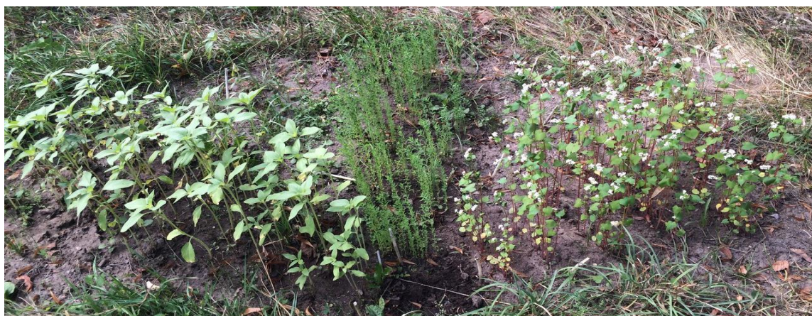
Рис. 5.11. Дослідження латеральної міграції нафти у ґрунт за участю рослин соняшника, льону та гречки. А – у рік забруднення (липень, 2015 р.) Б – через рік після внесення забруднення (липень, 2016 р.).
