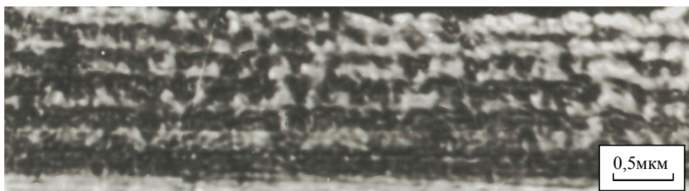
Рис. 7.18. Фотография поперечного сечения пленки, состоящей из чередующихся слоев \alpha - и \beta -Co.
