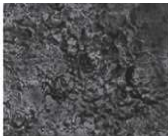
Рис. 4. Поверхня сплаву \text{Fe}_{55.9}\text{Ni}_{44.1} , отриманого імпульсним струмом f=200 Гц, Q=8 , \times 13000
