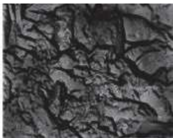
Рис. 3. Поверхня електролітичного заліза, отримана на постійному струмі \times 20000
